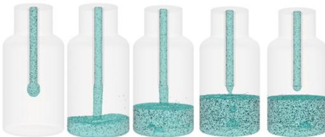
Slika 4: Razvoj tokovnega polja (tekočina z nedeformabilnimi mikrodenci) med polnjenjem vijale: 0,05 s; 0,5 s; 1,0 s; 1,45 s in 2 s (od leve proti desni).
