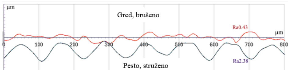
Slika 5: Posneti profil površinske hrapavosti za gred in pesto pri referenčni dolžini 800 \mu\text{m} v začetnem dotiku brez sile
