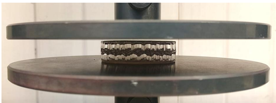
Slika 1: Prikaz postavitve preizkušancev med tlačne čeljusti.
