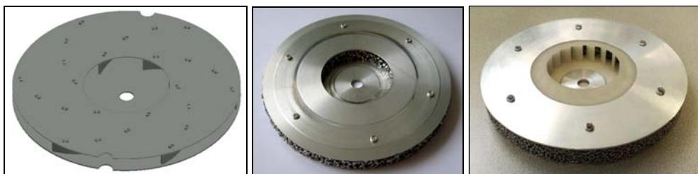
Slika 2: Fotografija običajnega lopatičnega turbokolesa na desni, turbokolesa iz poroznega materiala v sredini ter turbokolesa iz poroznega materiala z dodanim radialnim inducerjem.
